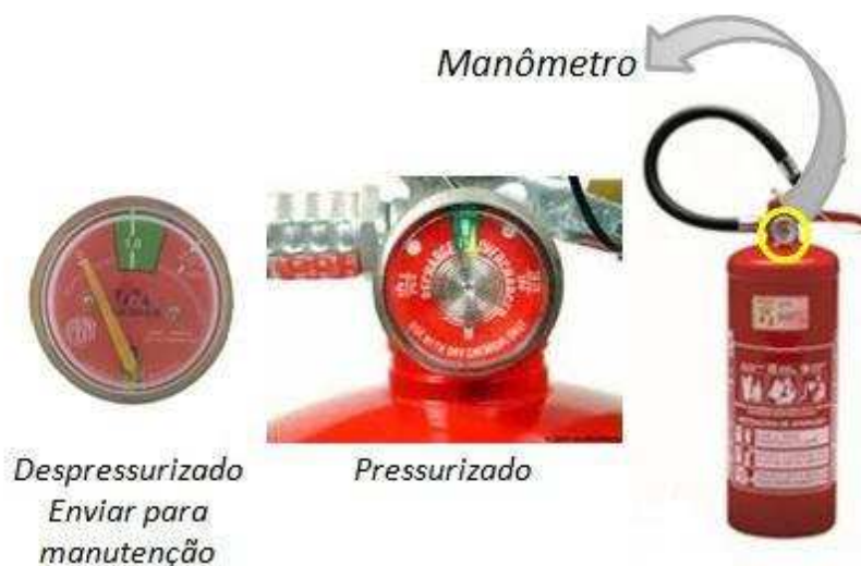
Figura 31 - Indicação de pressurização do extintor de incêndio
