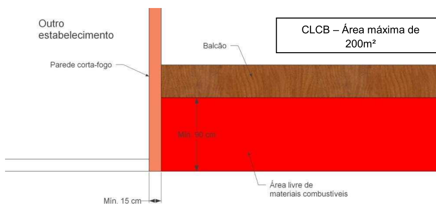
Figura 11 – Solução Técnica 03 – Recuo de 90 centímetros com exigência de área livre de materiais combustíveis (balcão de atendimento).
