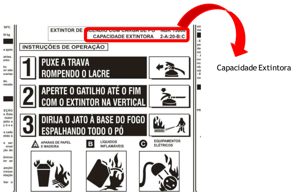
Figura 26 - Capacidade extintora no quadro de instruções (rótulo) do extintor
