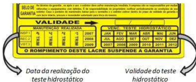
Figura 30 - Selo de garantia dos extintores de incêndio inspecionados
